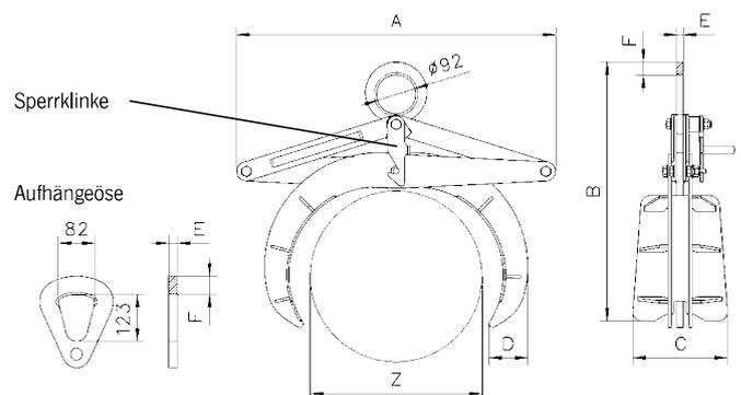
Modell TRU, Aufhängeöse für Greifer ab 2.000 kg Nutzlast. Die Sperrklinke dient der Verriegelung in geöffneter Stellung.
